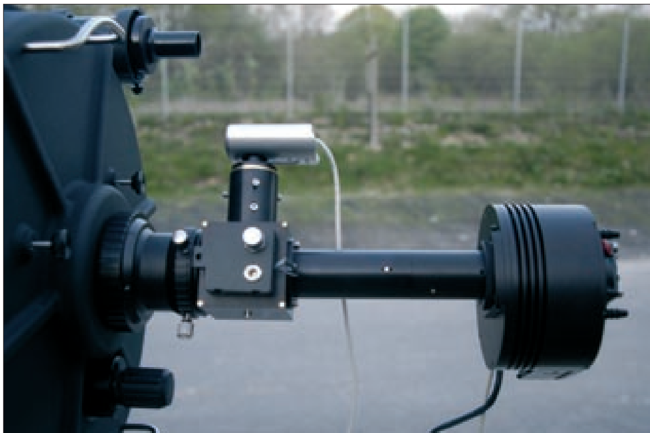
Figura 4. TRAGOS acoplado al foco de un telescopio Celestron de 14". Como cámara de guiado usamos una webcam Philips ToUcam Pro II, y para la adquisición de los espectros estelares una CCD SBIG ST7.
