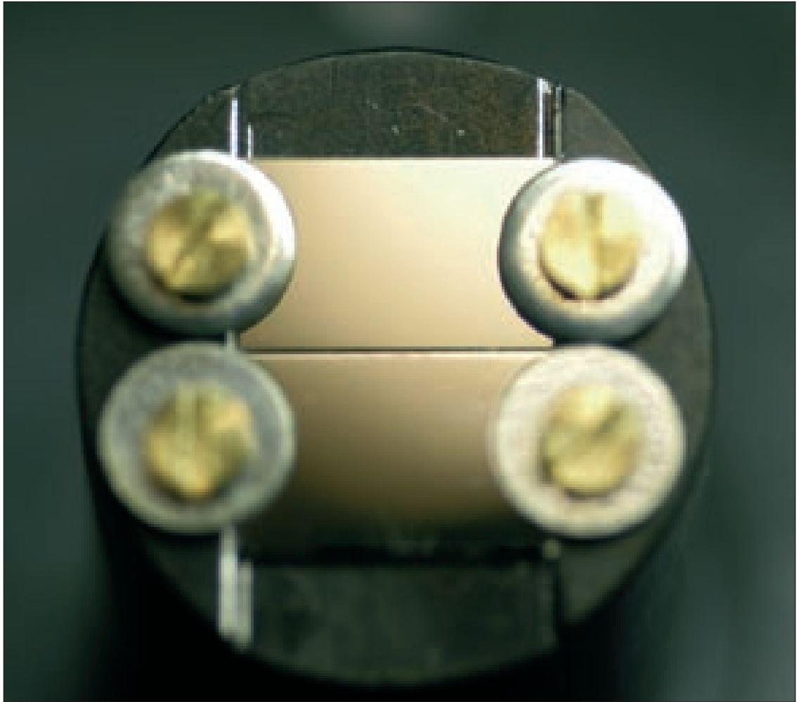
Figura 5. Detalle de la rendija de entrada de luz al instrumento.
